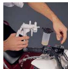
**1.** Bremsflüssigkeit aus dem Ausgleichsbehälter absaugen.
