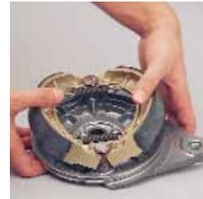
**5.** Kupferpaste an die Auflagepunkte der Bremsbeläge montieren.
