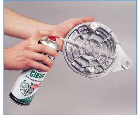
**3.** Bremsträgerplatte mit Bremsenreiniger säubern
