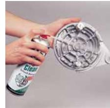
**3.** Bremsträgerplatte und Bremstrommel ausgiebig reinigen.
