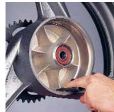
**6.** Bremstrommel untersuchen und ggf. mit Schmirgel abziehen.
