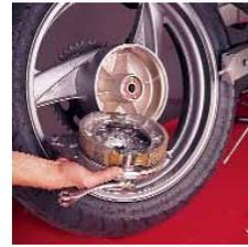
**1.** Hinterrad ausbauen und Bremsträgerplatte abnehmen.
