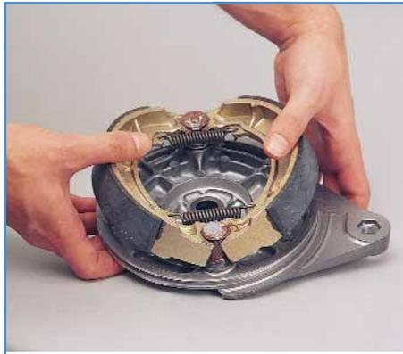
**5. Neue Beläge montieren**
