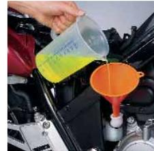
4. Ausgleichsbehälter befüllen. Nach Abkühlung nochmals kontrollieren.
