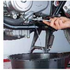
1. Ablassschraube und Einfülldeckel öffnen.
