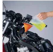
3. Kühlmittel einfüllen und Motor starten. Temperatur & Kühlmittel-Level im Auge behalten.
