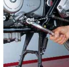
2. Ablassschraube mit neuer Dichtung versehen und mit dem Drehmoment-schlüssel festziehen.
