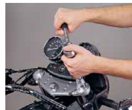
7. Montage mit Hammer, oder besser: Gabeldichtring-Eintreiber
