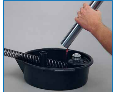
3. Obere Gabelverschluss-schraube entfernen und Gabelöl ausgießen.
