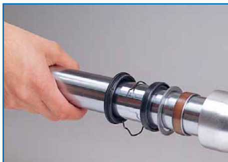
6. Defekten Dichtring entfernen
