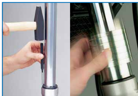
7. Montage mit Hammer, oder besser: Gabeldichtring-Eintreiber
