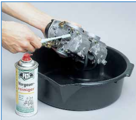
4. Vergaser äußerlich reinigen
