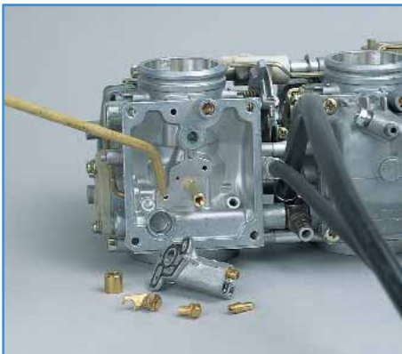
9. Mit Druckluft die Bohrungen freipusten
