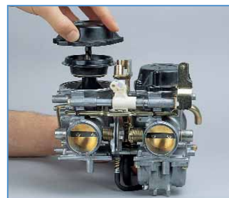
7. Unterdruckkolben ausbauen und Membrane prüfen
