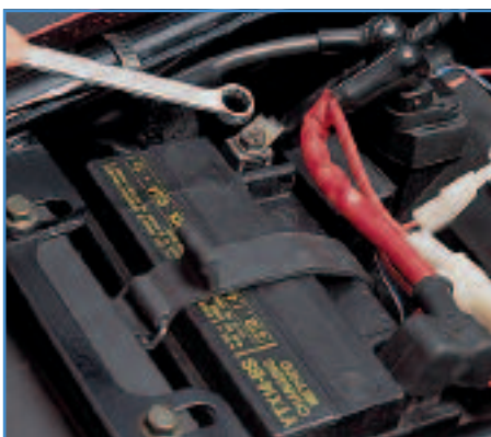
2. Zuerst das Minuskabel und dann das Pluskabel lösen
