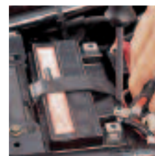
5. Das Pluskabel vor dem Minuskabel befestigen.
