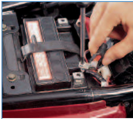
5. Zuerst das Pluskabel und dann das Minuskabel befestigen
