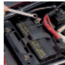
2. Das Minuskabel vor dem Pluskabel abbauen.
